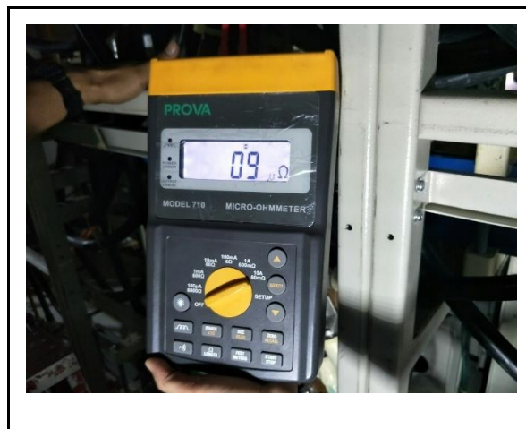
ภาพขณะทำการ CONTACT RESISTANCE TEST
